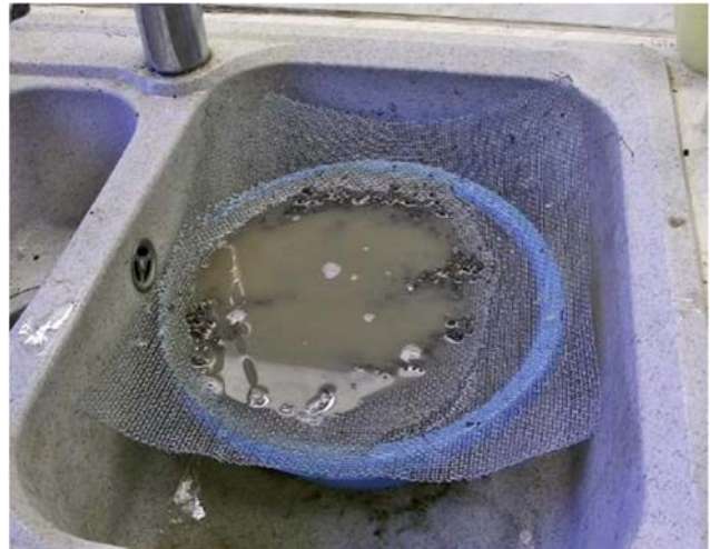
9. ábra A 2-5 mm-es frakció fennmarad a szitán. Könnyebb víz alatt szitálni!
