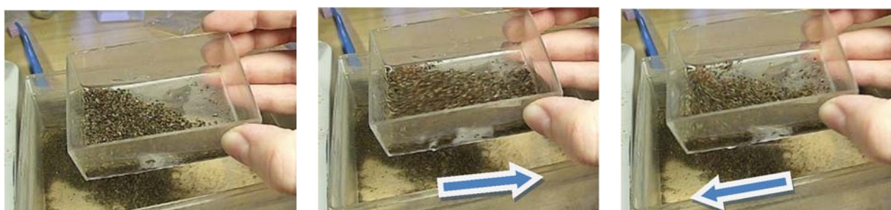
17. ábra Nehezebb szemcsék ülepedése két merítés között.
