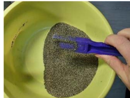
12. ábra A mágneses anyag kisedése a kiszáritott frakcióból. Ha erős a mágnesünk, húzzunk rá zacskót. Úgy könnyebb a rátapadt magnetites hordalék leválasztása.
