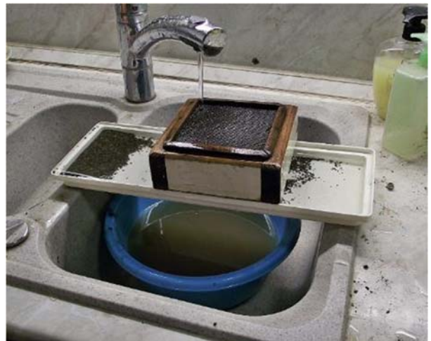
11. ábra 1-2 mm-es frakció fennmarad a szitán. Itt is jobb víz alatt szitálni! A képen már az látható, ahogy szitálás után a fejjel lefelé fordított szitából kimosom a tálcára a hordalékot.
