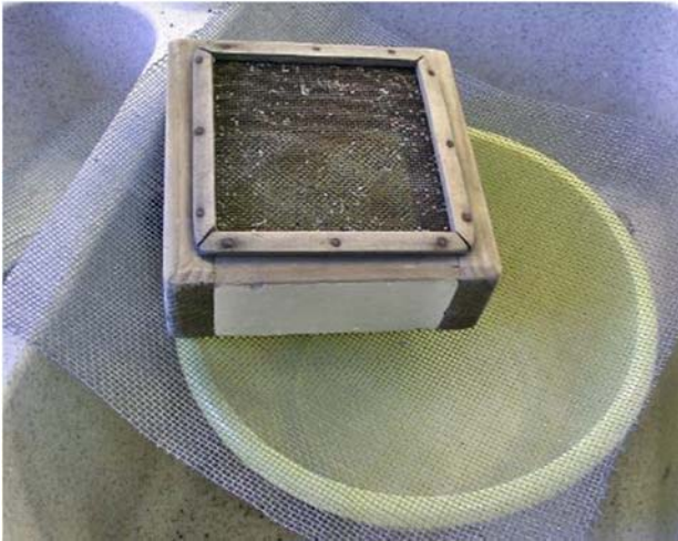
8. ábra Felszerelés: 2 mm-es és 1 mm-es sziták
