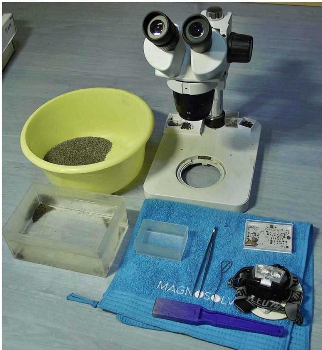
14. ábra Sűrítetlen frakció a sárga edényben. Sztereo mikroszkóp 15x és 30x nagyítással. Kicsit kisebb nagyítás (8-10x) jobb lenne. Alsó megvilágításhoz fejlámpa tölthető elemekkel. Mágnes, csipesz és matatáshoz egy meghajlított gépkapocs. Edény vízzel és műanyag ásványos doboz fedele a merítéshez. Törölköző a víz letörléséhez. Műanyag dobozok a kiválogatott szemcsékhez.
