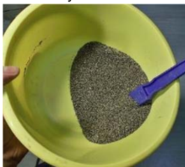
12. ábra A mágneses anyag kisedése a kiszáritott frakcióból. Ha erős a mágnesünk, húzzunk rá zacskót. Úgy könnyebb a rátapadt magnetites hordalék leválasztása.
