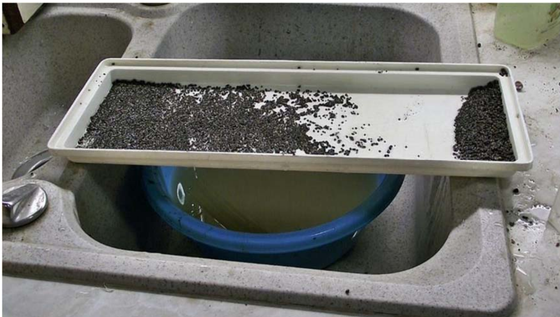
13. ábra Lögybőlés után bal oldalt van a gránátos hordalék. A vizet már leöntöttem a tálcáról, hogy elkészíthessem a képet!
