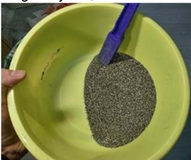
12. ábra A mágneses anyag kisedése a kiszáritott frakcióból. Ha erős a mágnesünk, húzzunk rá zacskót. Úgy könnyebb a rátapadt magnetites hordalék leválasztása.
